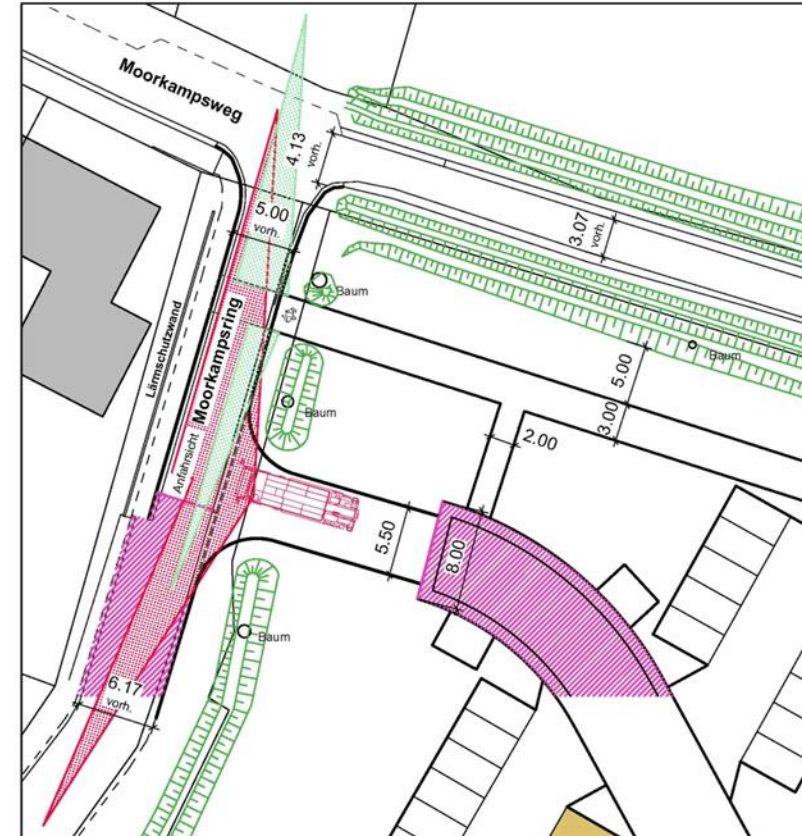
Einmündung VARIANTE 3 1: 500 [Pink hatched area] Beginn des verkehrsberuhigten Bereiches [Person symbol] Standort Person [Car symbol] Standort Fahrzeug [Red triangle] Sichtdreieck Fahrzeug [Green line] Sichtdreieck person
